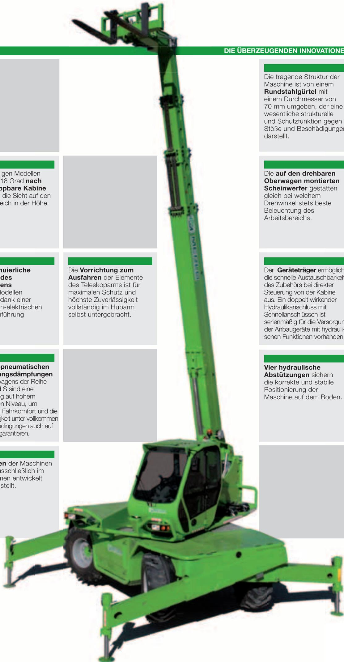
Die tragende Struktur der Maschine ist von einem **Rundstahlgürtel** mit einem Durchmesser von 70 mm umgeben, der eine wesentliche strukturelle und Schutzfunktion gegen Stöße und Beschädigungen darstellt.
